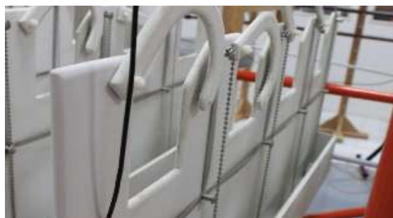
Slika 9. Stol za ispitivanje izolacijskih motki
