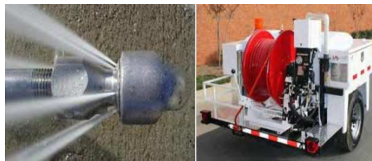
Slika 4. Mlaznica (lijevo) i prikolica za ispiranje (desno) [8]
