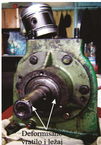
Fig. 3. Dijagnostikovanje stanja klipnog kompresora [7]
