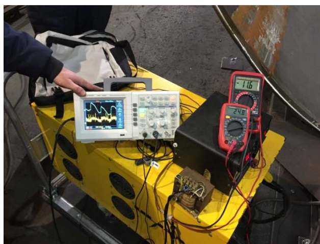
Slika 4. Promjenjivi otpornik s mjernom opremom
