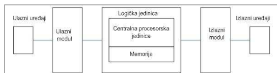
Slika 1. Osnovni elementi programabilnog logičkog kontrolera (PLC); Izvor: [6,5]
