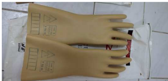
Slika 7. Primjer izolacijskih rukavica za RPN
