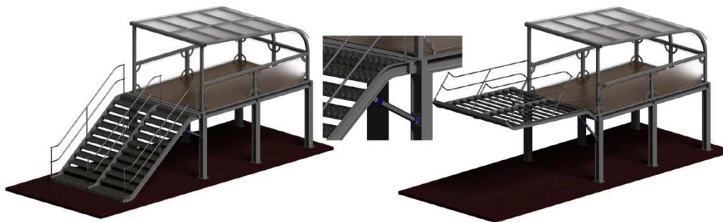
Sl. 2. Konceptijska varijanta metalne konstrukcije nadstrešnice
