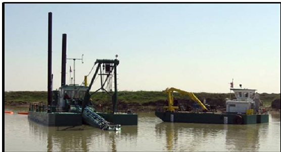
Slika 4. Plovni bager za održavanje plovnih putova [7]
