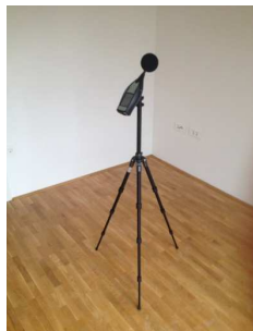
SI. 10. Zvukomjer postavljen na pripadajući stalak s podesivom visinom.
