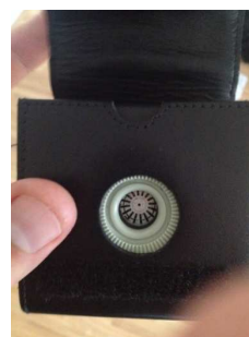
SI. 9. Kalibrator za umjeravanje zvukomjera.
