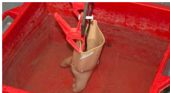
Slika 8. Ispitivanje izolacijske rukavice
